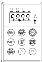
Fig.b waiting status, display waiting status parameter
